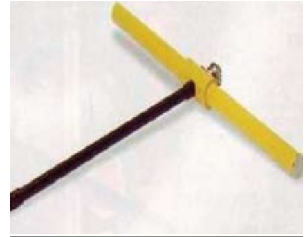
شكل رقم (١١) مثقاب يدوي Increment borer) يستخدم لعمل ثقوب في جذع النخلة
