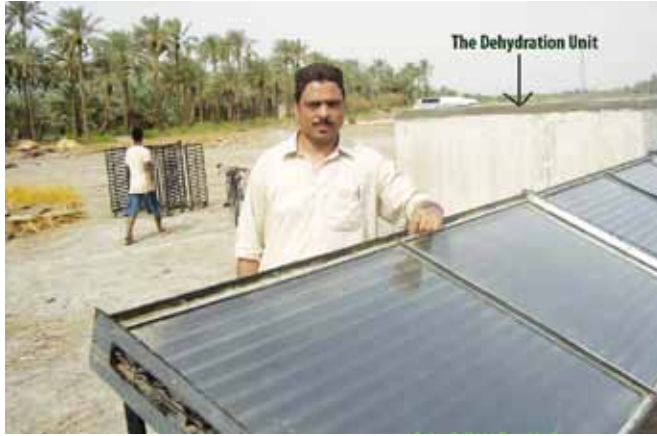
شكل رقم (6) أحد أشكال المجففات التي تعمل بالطاقة الشمسية للإسراع من تجفيف الثمار بعيداً عن الجو المفتوح تحت أشعة الشمس وبالقرب من التلوث بالأتربة (خيربور - موسم 2010)
