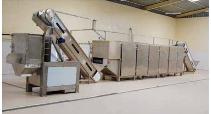
خط إنتاج عجينة التمور بطاقة 1000 كغم بالساعة
