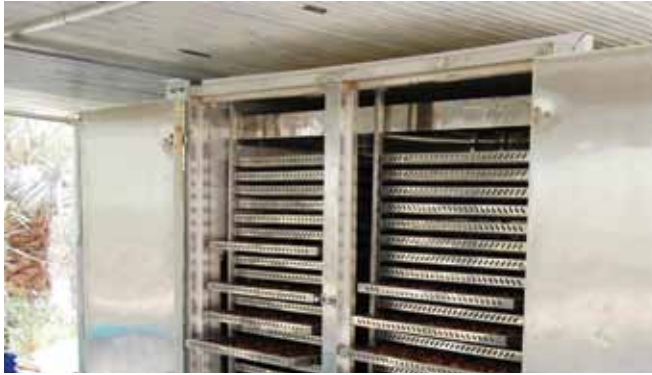
جهاز تجفيف التمور سعة 900كغم
