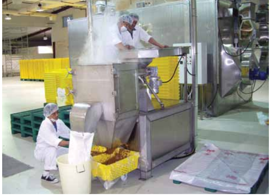
ماكينة إنتاج عجينة التمور بطاقة 300 كغم بالساعة
