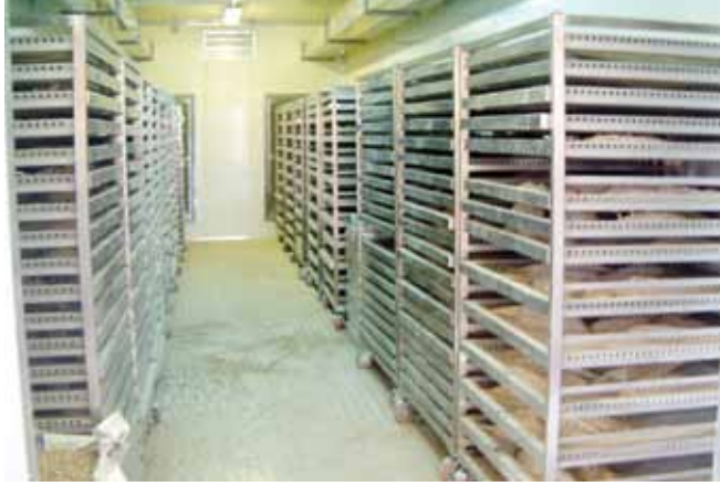
جهاز تجفيف حبوب اللقاح الحديثة (التصميم الجديد) من الداخل تبين طريقة وضع الطلع الذكري داخل العربات
