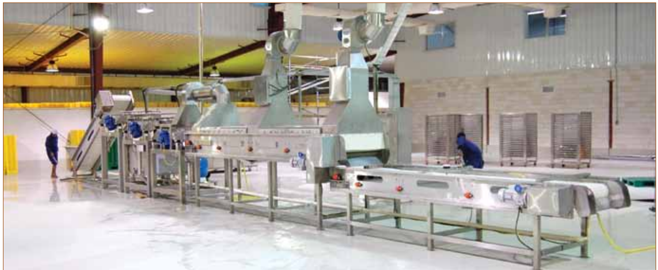
خط غسيل وتنشيف التمور بطاقة 1طن بالساعة
