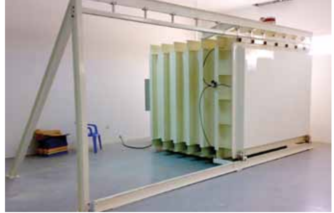
جهاز تعقيم التمور سعة 3طن
