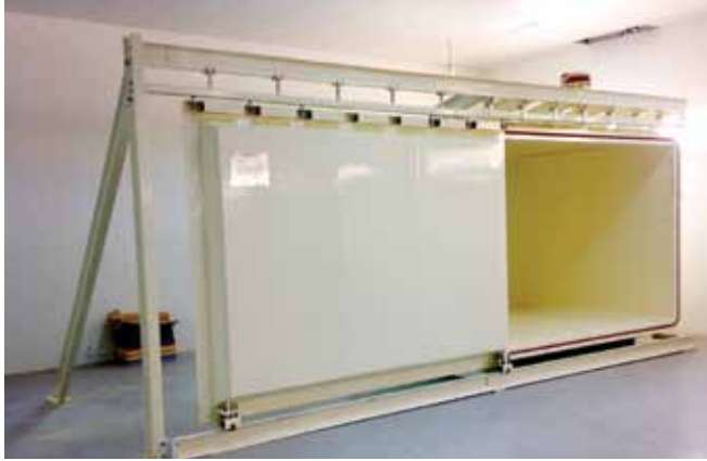
جهاز تعقيم التمور سعة 3طن
