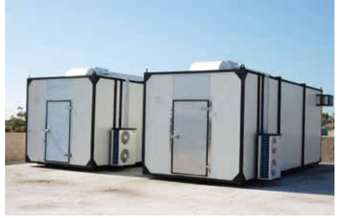
جهاز تجفيف التمور سعة 3000كغم
