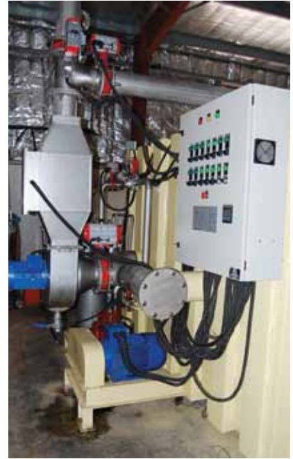
صور توضح أجهزة الترطيب والتجفيف المثبتة في جهاز التعقيم
