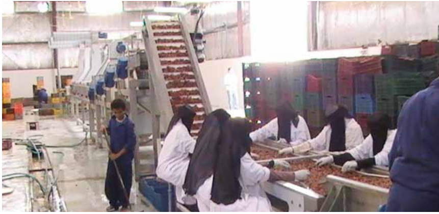
خط غسيل وتثفيف وفرز التمور بطاقة 5, 1طن بالساعة
