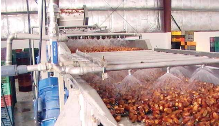
مرحلة غسيل التمور باستخدام جهاز الهزاز ومرشات الماء
