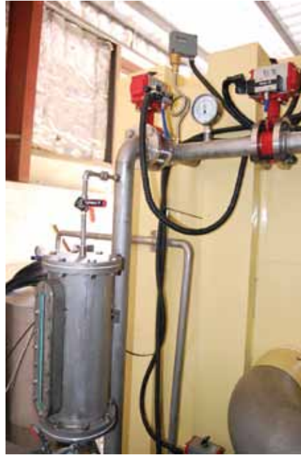
صور توضح أجهزة الترطيب والتجفيف المثبتة في جهاز التعقيم
