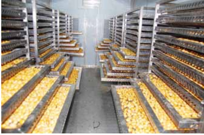
جهاز تجفيف التمور سعة 3000كغم
