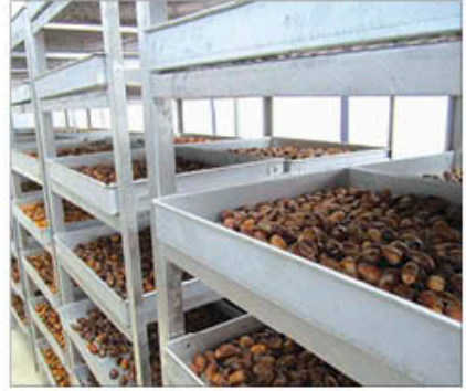
شكل رقم 32. جانب من النفق الشمسي لتجفيف ثمار التمر في باكستان بطاافة نصف طن ثمار مجففة/3 أيام
