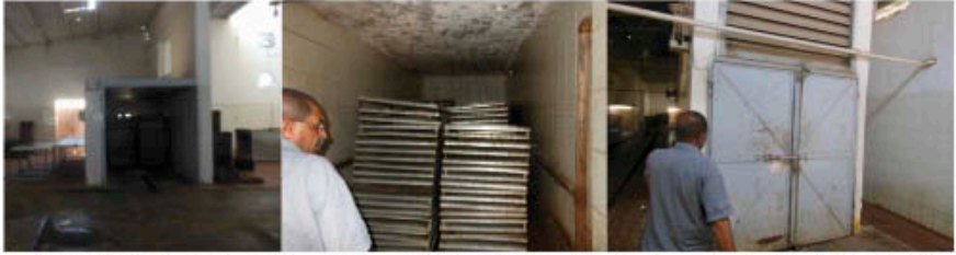
(أ) وحدة البخار الساخن من الخارج (ب) حوامل صواني التمار من داخل وحدة البخار. (ج) وحدة التهوية بعد البخار الساخن.
