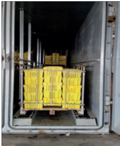
شكل رقم 9: وضع صناديق التمر داخل غرفة التخبير واغلاقها بإحكام (مصنع التمر بالأحساء)
