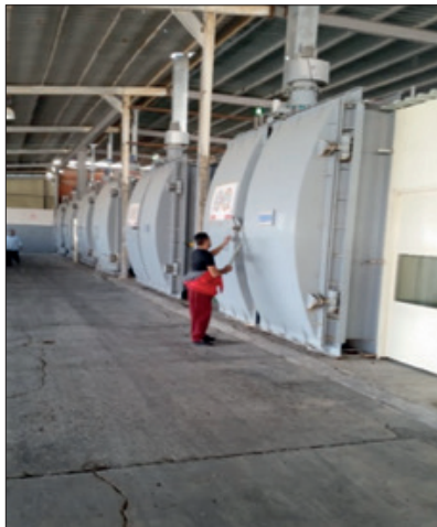
شكل رقم 9: وضع صناديق التمر داخل غرفة التخبير واغلاقها بإحكام (مصنع التمر بالأحساء)
