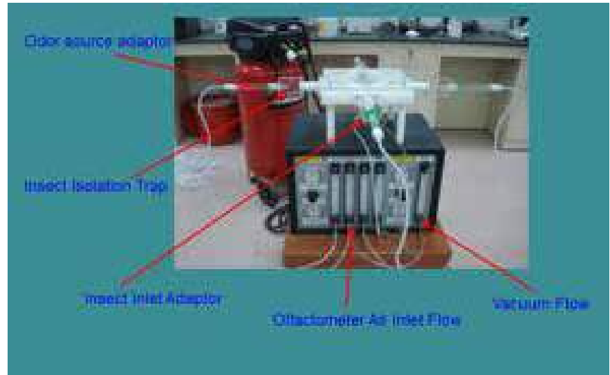
شكل رقم 6: جهاز قياس حاسة الشم في الحشرات
