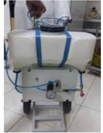
صورة (15) توضح طريقة الحقن اليدوي لمكافحة سوسة النخيل الحمراء
