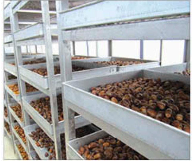
شكل رقم 32. جانب من النفق الشمسي لتجفيف ثمار التمر في باكستان بطافة نصف طن ثمار مجففة/3 أيام
