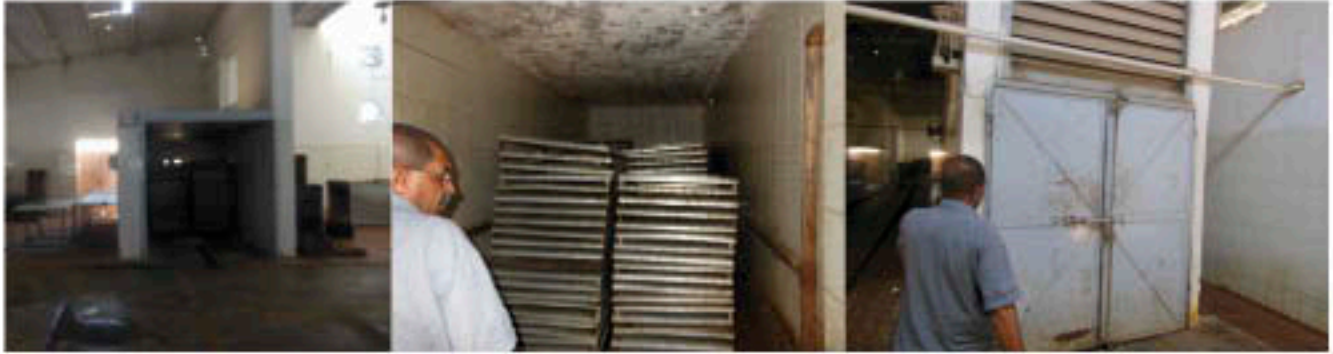
(أ) وحدة البخار الساخن من الخارج (ب) حوامل صواني الثمار من داخل وحدة البخار. (ج) وحدة التهوية بعد البخار الساخن.
