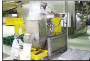
ماكينة إنتاج عجينة التمور بطاقة 300 كغ بالساعة
