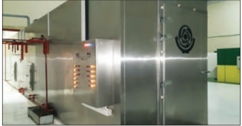
شكل رقم 4 (ب) جهاز يستخدم تقنية البخار الجاف والمشيح تحت تفريغ الهواء لتجفيف التمور
