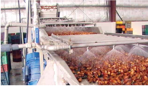
مرحلة غسل التمور باستخدام جهاز الهزاز ومرشات الماء
