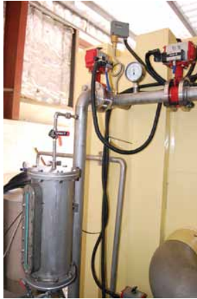
صور توضع أجهزة الترتيب والتجفيف المثبتة في جهاز التعقيم
