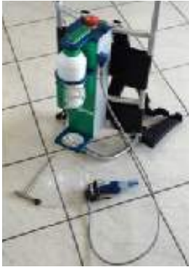
جهاز الحقن المجهري (Syngenta TMI) محضر لعملية الحقن بعد تركيب عبوة المبيد بداخله
